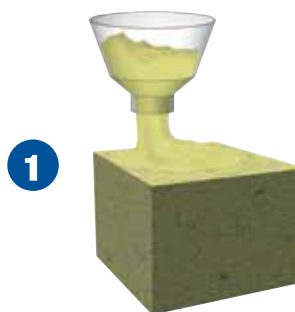
PENETRON ADMIX se dodaje u beton tokom njegove pripreme.
